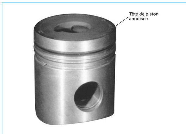
**Figure 12 – Tête de piston traitée par anodisation dure**
